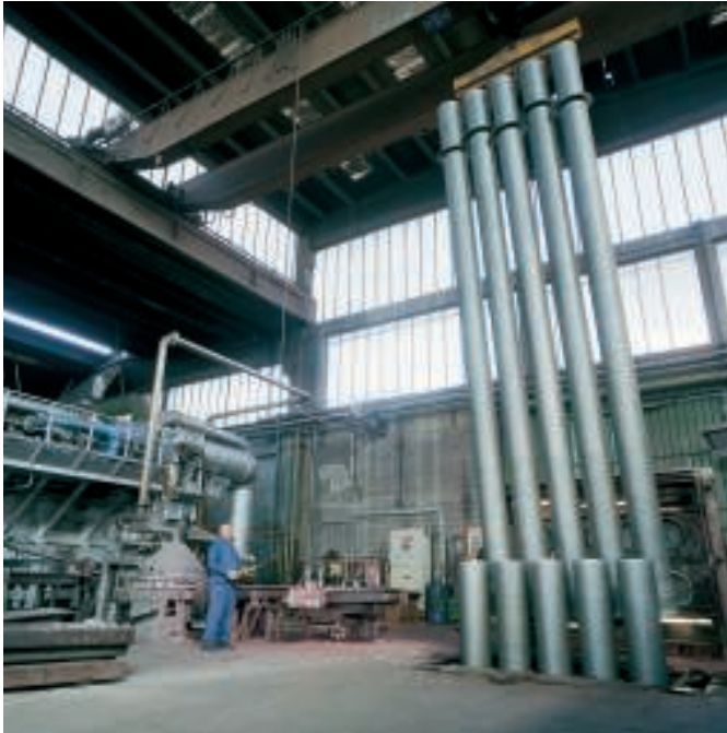
▲ Nell'immagine sono visibili le billette estratte dai forni dello stabilimento Eural Gnutti di Pontevedo. L'integrità del materiale è garantita su tutte le billette da un sistema automatico di controlli a ultrasuoni in classe A secondo la norma SAE AMS-STD 2154
