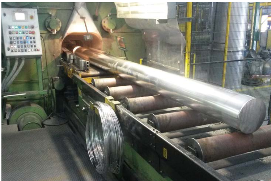
Pressa di estrusione inversa da 5500 ton.
