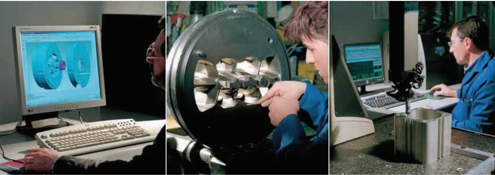
Un estruso per cilindri pneumatici di qualità parte sempre da una attenta progettazione della matrice.
